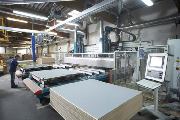
Abbildung 4 Produktion von VANYCARE ® -Laderaumschutzausstattung auf modernen CNC-Bearbeitungszentren
