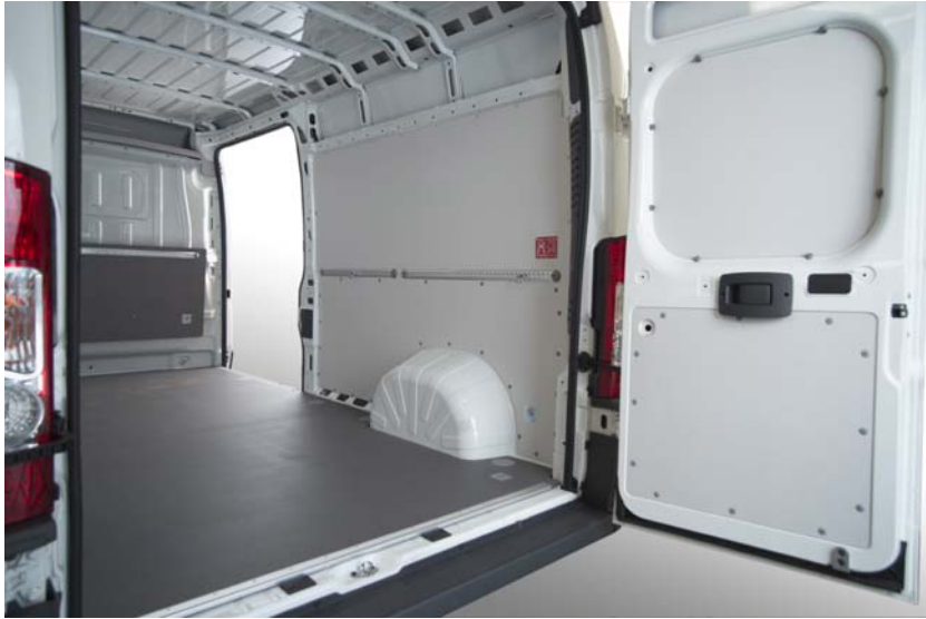
Abbildung 2 Fiat Ducato mit VANyCARE ® -Komplettausstattung (Boden, Wand, Rammschutz incl. Zurrstreifen)
